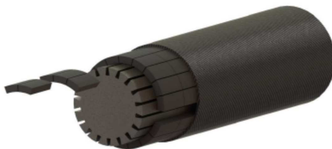
Рисунок 11: 3D модель ротора. Магниты разделены на сегменты и расположены между ярмом ротора и удерживающим кожухом
